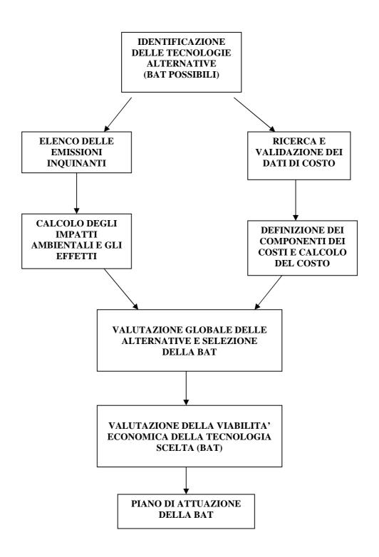
Fig. 3. Schema della procedura di valutazione e selezione di una BAT
