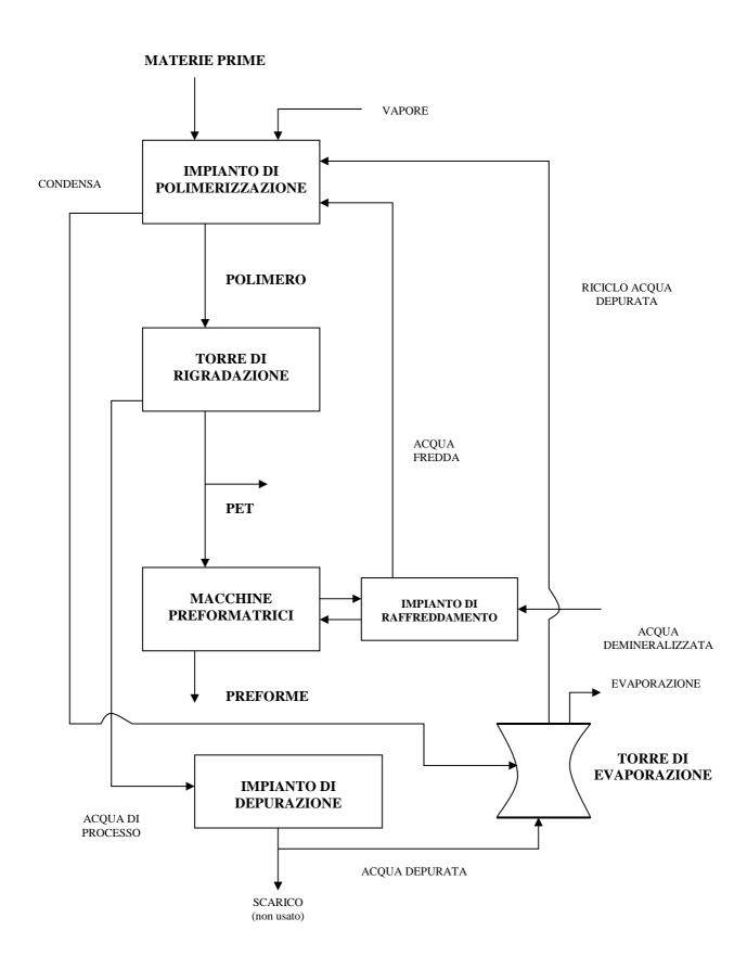
Fig. 6. Schema dell'impianto di depurazione dell'ITALPET
