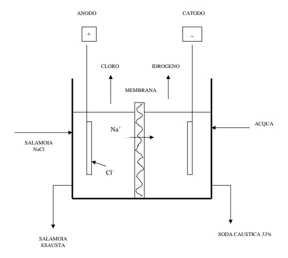
Fig. 5. Produzione di cloro con celle a membrana
