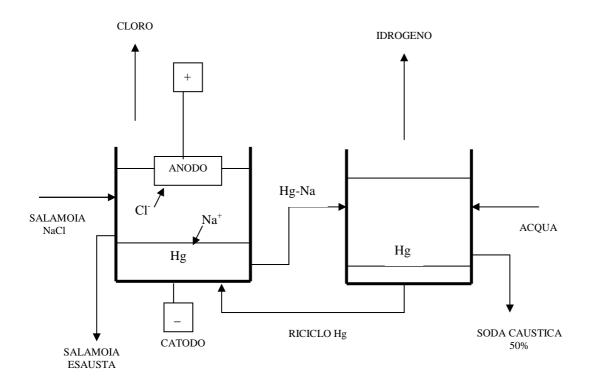
Fig. 4. Produzione di cloro con celle a mercurio (Hg)
